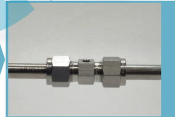
Wiederholen Sie den Vorgang auf der zweiten Seite. Die Schneidringe sind nun am Rohr fest aufgespresst.
